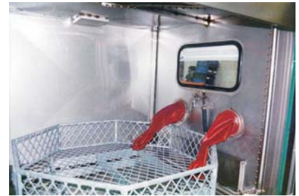
Spritzkabine mit Korb, Düsenrahmen und optionaler Handwascheinrichtung.
