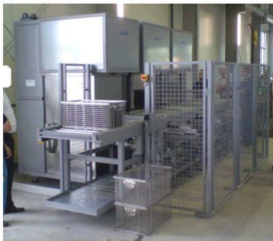
mehrere ROTOREn 67 als Vollautomat verkettet
